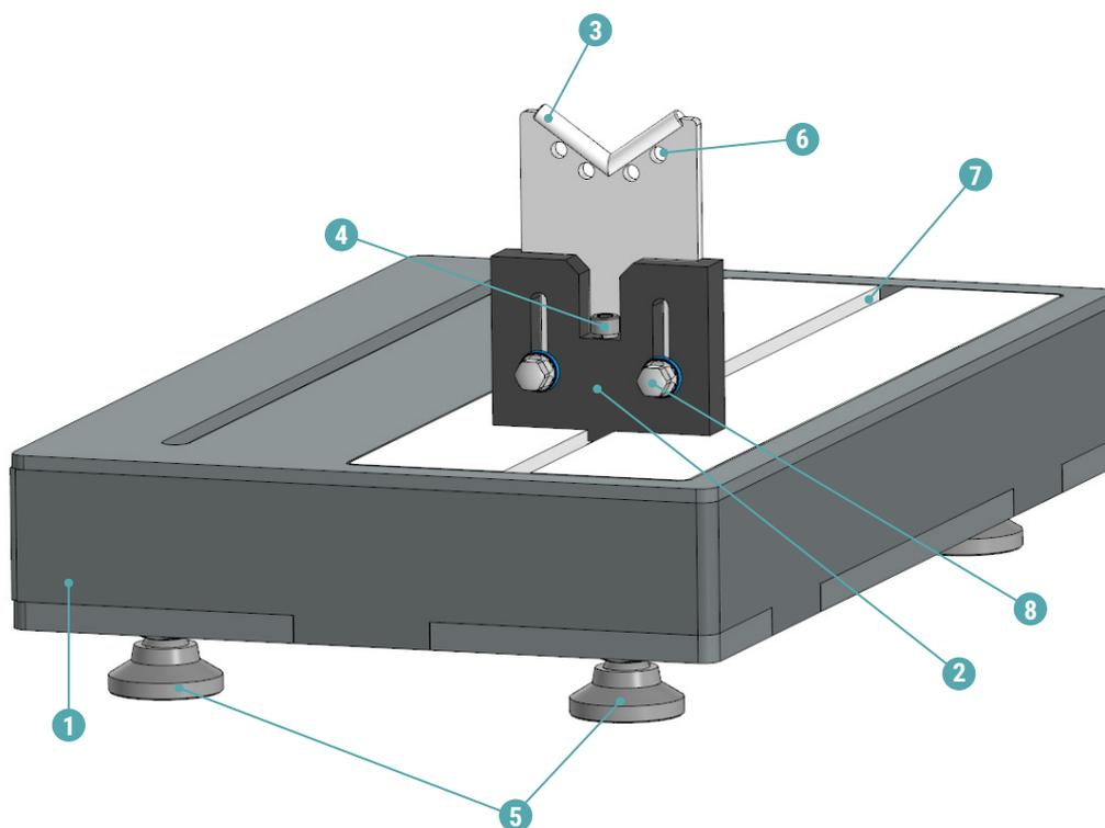
1 – станина; 2 – опора; 3 – призма; 4 – винт фиксации опоры; 5 – виброопора станины (4 шт.); 6 – крепление роликов; 7 – Т-образный паз; 8 – регулировка высоты.
