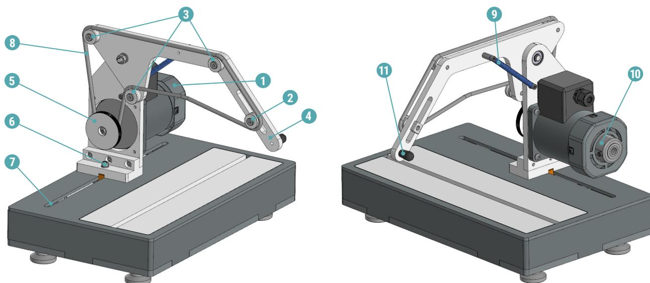
1 – электропривод; 2 – натяжной ролик; 3 – ролик; 4 – откидная часть ременного привода; 5 – ведущий шкив ременного привода (сменный); 6 – винт фиксации ременного привода на станине; 7 – паз для установки ременного привода; 8 – ремень; 9 – пружина; 10 – энкодер; 11 – ручка перемещения привода.
