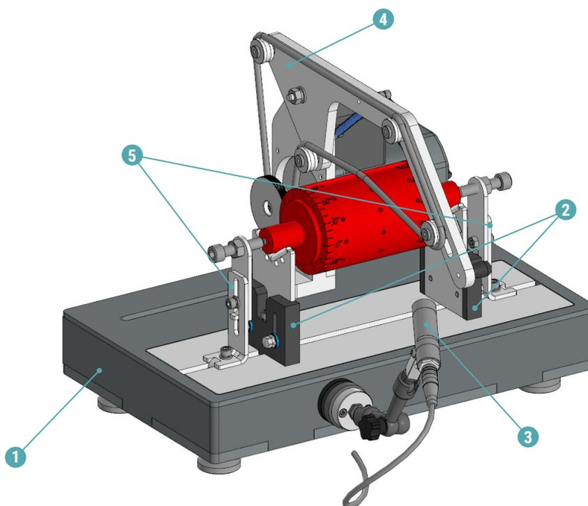
1 – станина; 2 – опоры; 3 – отметчик оборотов лазерный; 4 – ременный привод; 5 – осевой упор.
